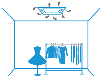
Distribution de l'air avec un filtre encrassé
